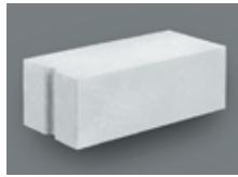
mos blokeliai naudojami kaip klojiniai, o projektuojant laikomasi bendrujų betoninių ir gelžbetoninių konstrukcijų projektavimo taisyklių. U formos blokeliai gaminami 200 mm, 250 mm, 300 mm, 375 mm ir 500 mm pločio, jų aukštis lygus 200 mm, o ilgis – 500 mm.
